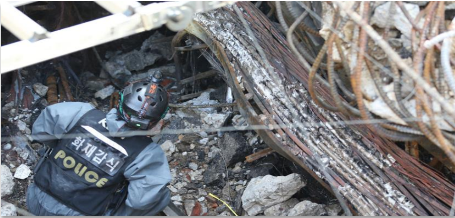
2018년 아현동 K사 전력 Cable 화재발생으로 감식반이 조사하는 모습
